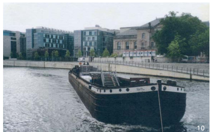
Museumsschiff „Hertha“ Berliner Maßkahn Baujahr: 1912 Länge: 46,62 m, Breite: 6,59 m
