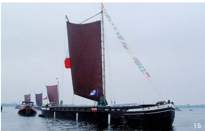
15 „Bastei“ Finowmaßkahn Baujahr: 1923 Länge: 40,7 m, Breite: 4,78 m
