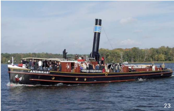
„Andreas“ Dampfschlepper Baujahr: 1944/45 Länge: 35,18 m, Breite: 6,93 m
