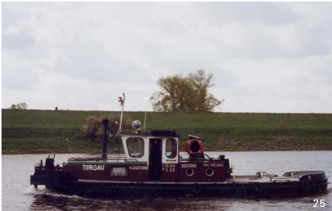
„Torgau“ Schubschleppboot Baujahr: 1959 Länge: 12,94 m, Breite: 3,20 m
