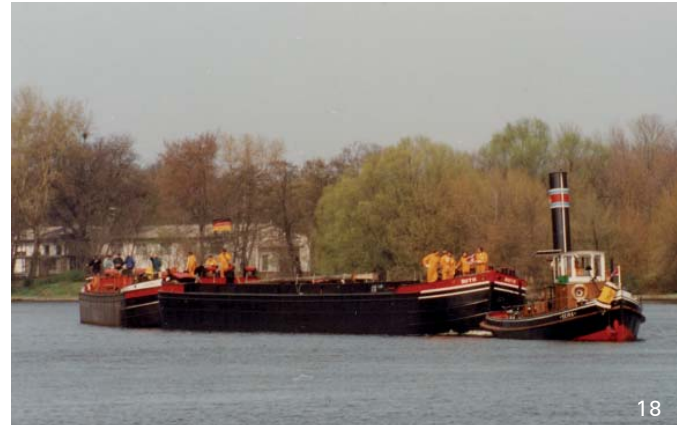
„Ruth“ Groß-Finow-Maßkahn Baujahr: 1926 Länge: 41,6 m, Breite: 5,08 m
