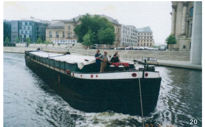
Museumsschiff „Helene“ Saale-Maßkahn Baujahr 1928 Länge: 51,92 m, Breite: 6,20 m
