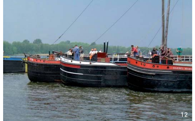
12 „Triton“ (erstes Schiff von links) Finowmaßkahn Baujahr: 1916 Länge: 40,40 m, Breite: 4,71 m
