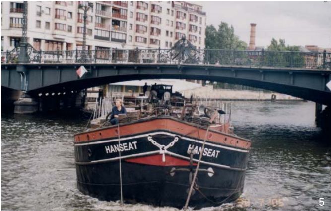
„Hanseat“ Saale-Maßkahn Baujahr: 1907, Bauort: Nienburg Länge: 52 m, Breite: 6 m, 400 t
