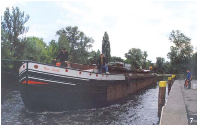
„Renate-Angelika“ Berliner Maßkahn Baujahr: 1910, Bauort: Aussig Länge: 46 m, Breite: 6,5 m, 465 t
