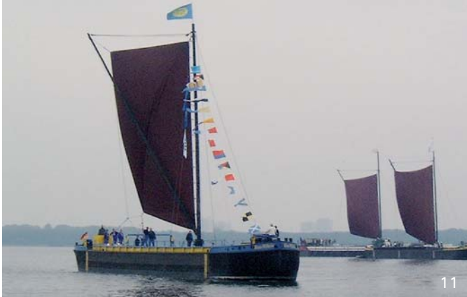
11 „Hans Wilhelm“ Groß-Finow-Maßkahn Baujahr: 1914 Länge: 40,30 m, Breite: 4,66 m
