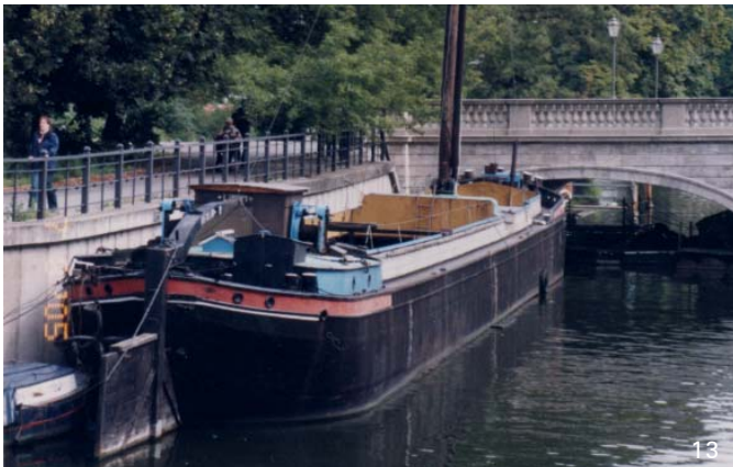
13 „Bärbel Marlies“ Finowmaßkahn Baujahr: 1918 Länge: 40,40 m, Breite: 4,76 m
