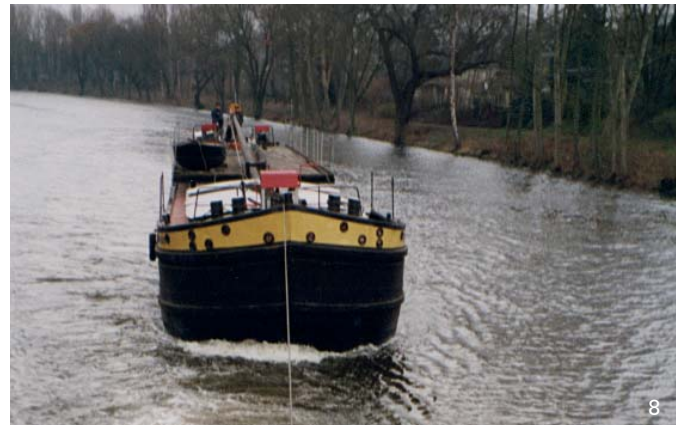
„Horst“ Finowmaßkahn Baujahr: 1910 Länge: 40,2 m, Breite: 4,73 m
